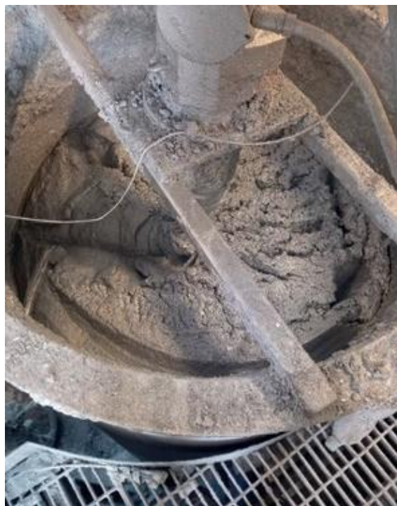
Рис 4: Выталкивание несмачиваемого алюминиевого порошка из смесителя в случае недостаточного количества ПАВ.
